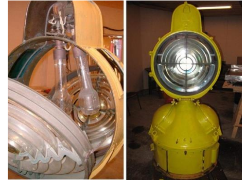
Lamporna inuti fyren, och fyren färdig att monteras upp. Foto Ulf Mellberg 2010.
